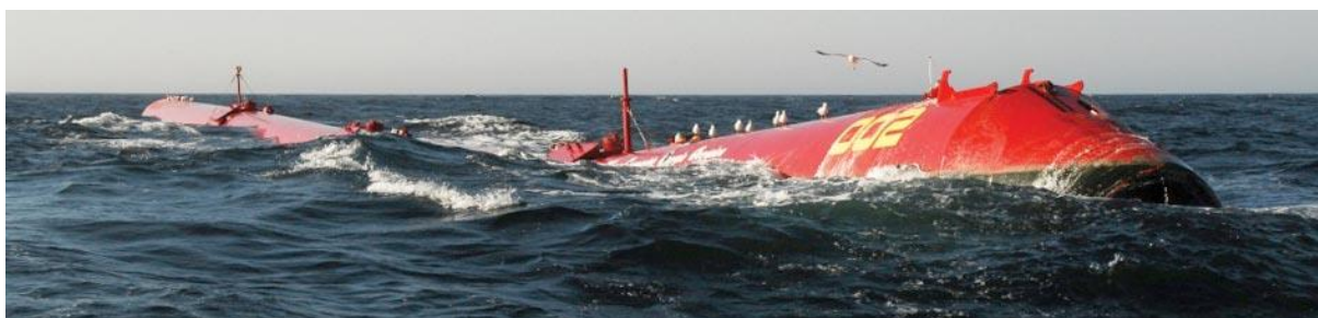
Figura 4 - Absorvedor de energia de ondas do tipo atenuador. Fonte: Pelamis.
