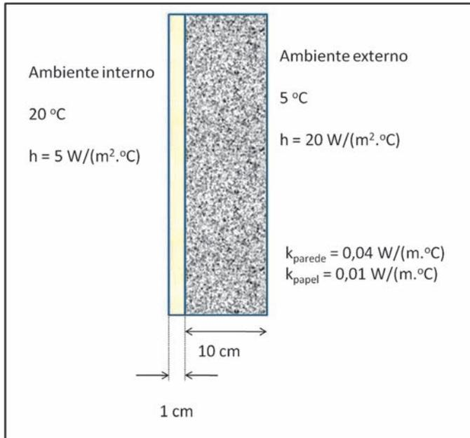
Considerando os valores de condutividade térmica indicados na figura, assim como as espessuras da parede e do papel e os coeficientes estimados de convecção para os ambientes interno e externo, seria correto o estudante chegar à conclusão de que o valor da razão (fluxo de calor sem o papel)/(fluxo de calor com o papel) estaria no intervalo de
