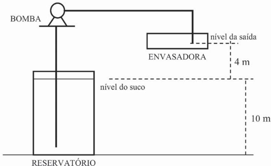
Considerando que o suco possua viscosidade desprezível e que a aceleração da gravidade  $g = 10 \text{ m/s}^2$ , qual deve ser a altura manométrica da bomba para que seja obtida uma vazão de envase de  $3 \text{ L/s}$ ?
